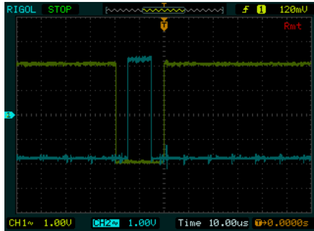
Şekil 3.7: dsPIC30F4011 için örnek ölü zaman incelemesi
