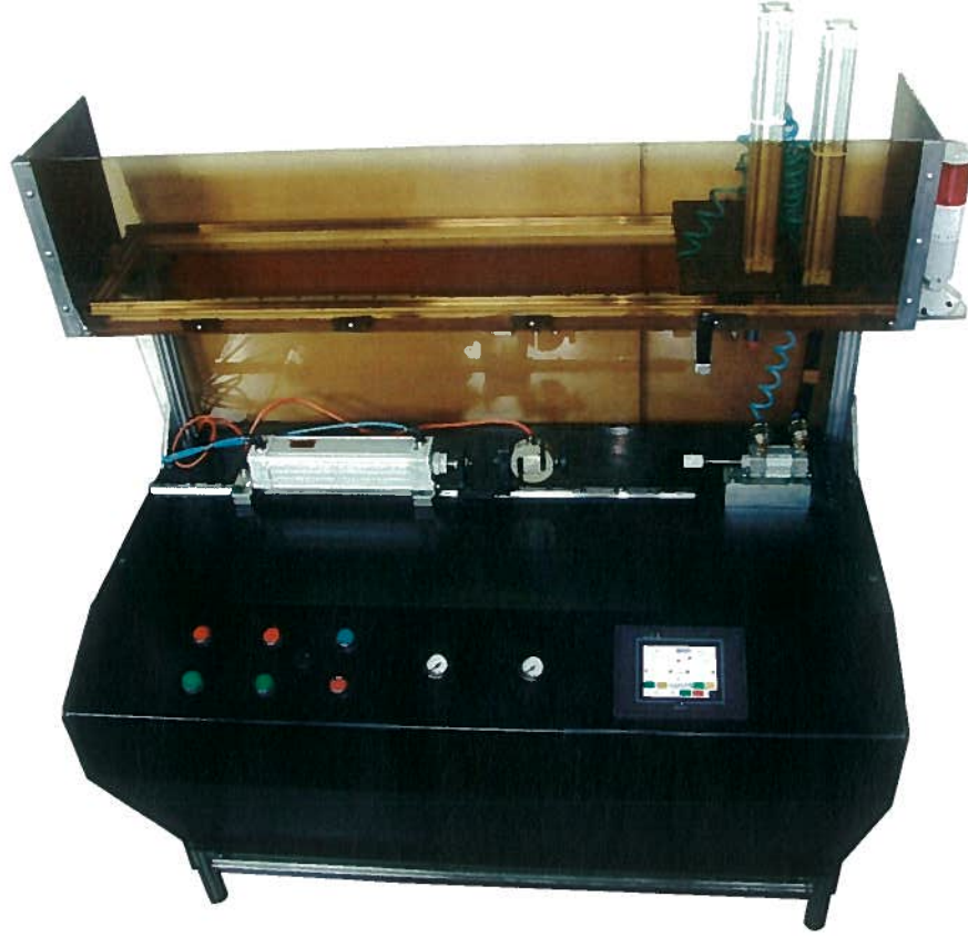
Şekil 7.2: Pnomatik silindir test makinası
