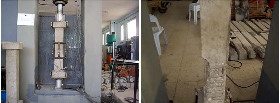
Şekil 4.205 KB1D12 Numunesinin Deney Sonundaki Görünüşü
