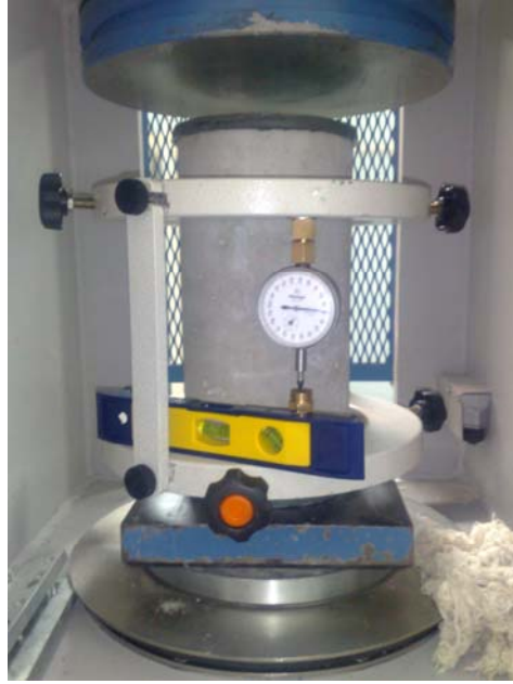
Şekil 4.8 Elastisite Modülünün Belirlenmesi için Oluşturulan Deney Düzeneği
