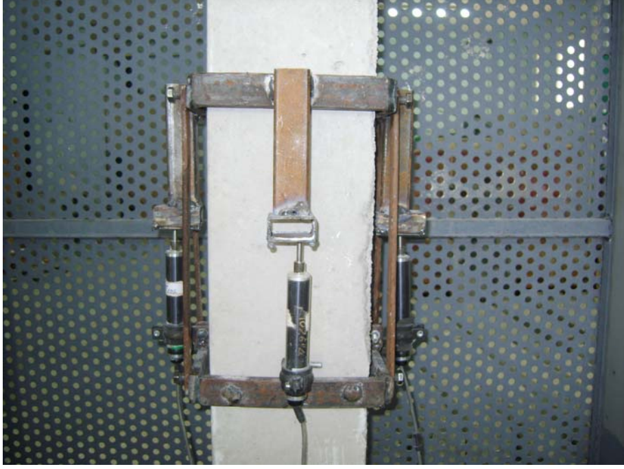
Şekil 4.10 Numuneye Sabitlenen LVDT'ler
