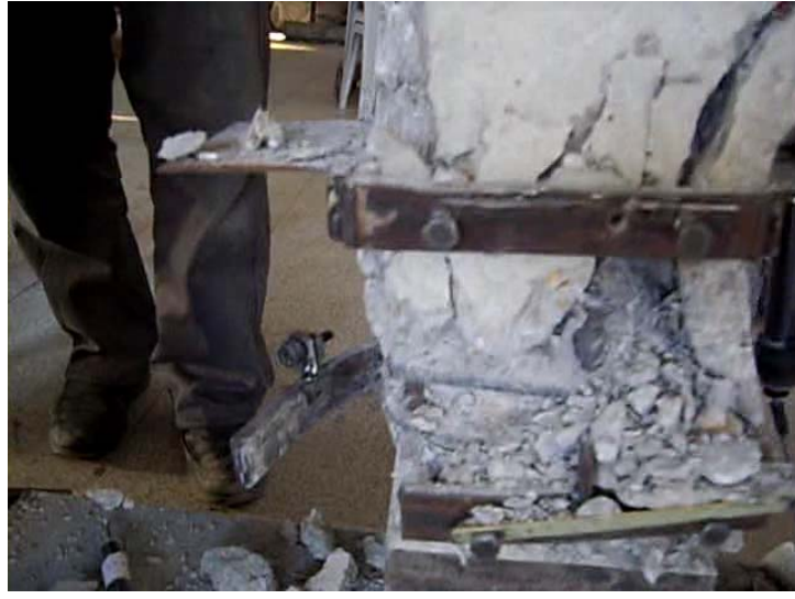
Şekil 4.78 LVDT Kelepçesinin Kaynaklarının Kopması ile Oluşan Görüntü
