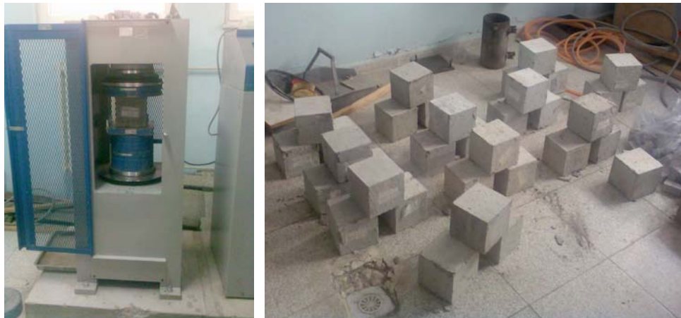
Şekil 4.6 Eksenel Basınç Dayanımı Belirlenen Küp Numuneler
