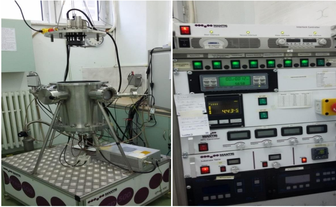
Şekil 3.5: DC Püskürtme sisteminin açık hali ve tüm parametreleri kontrol etmemizi sağlayan kontrol ünitesi.
