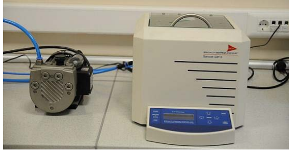
Şekil 3.1: Spin kaplama sistemi.
