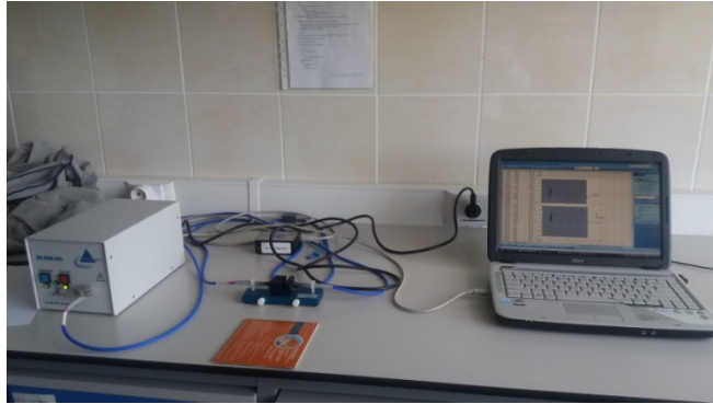
Şekil 3.2: UV-görünür bölge spektroskopisi sistemi.
