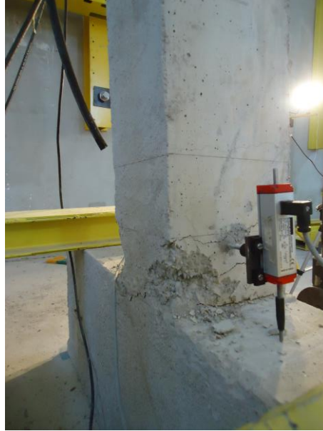
Şekil 4.62: SA414-2 KH performans düzeyi için numune hasar düzeyi
