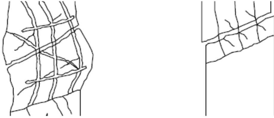
Şekil 3.9: Kolonlarda kesme hasarı
