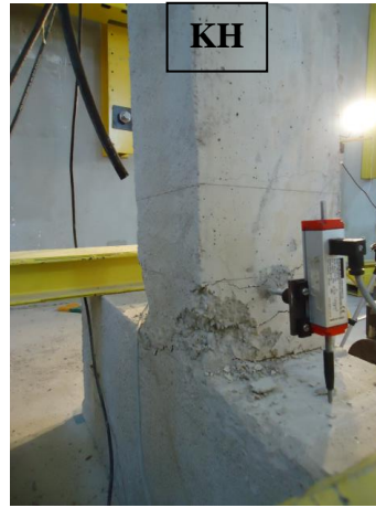
Şekil 4.64: SA414-2 numunesi hasar sınırlarına karşılık gelen hasar durumları
