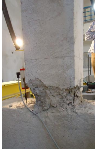
Şekil 4.61: SA414-2 GÖ performans düzeyi için numune hasar düzeyi
