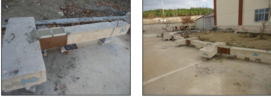
Şekil 4.25: Onarımları yapılmış numuneler
