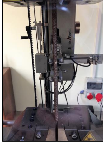
Şekil 4.5: Donatı çekme deneyi
