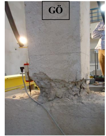
Şekil 4.64: SA414-2 numunesi hasar sınırlarına karşılık gelen hasar durumları
