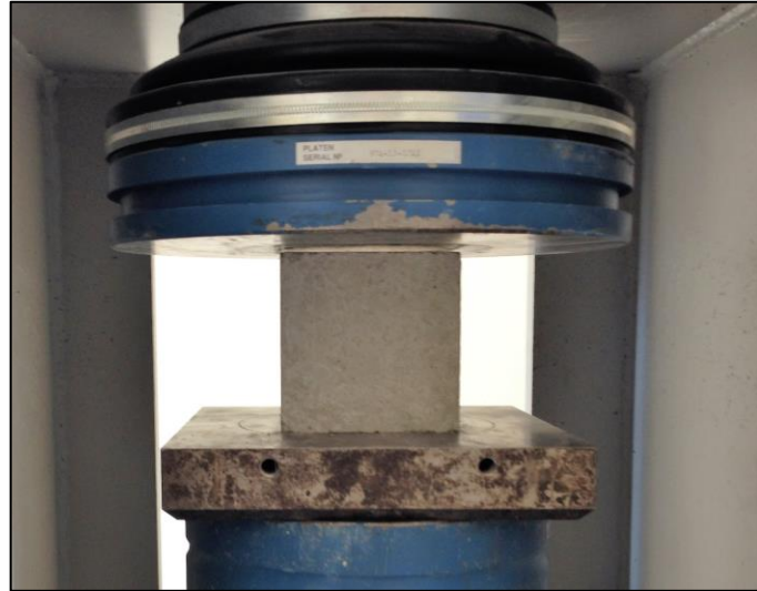
Şekil 4.4: Pres makinesine numunenin yerleştirilmesi ve basınç kuvveti uygulanması
