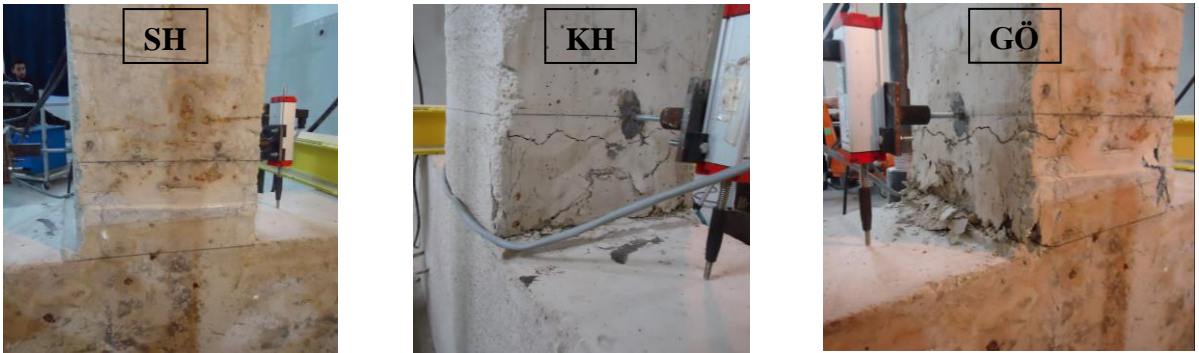
Şekil 4.73: SZ812-1 numunesi hasar sınırlarına karşılık gelen hasar durumları
