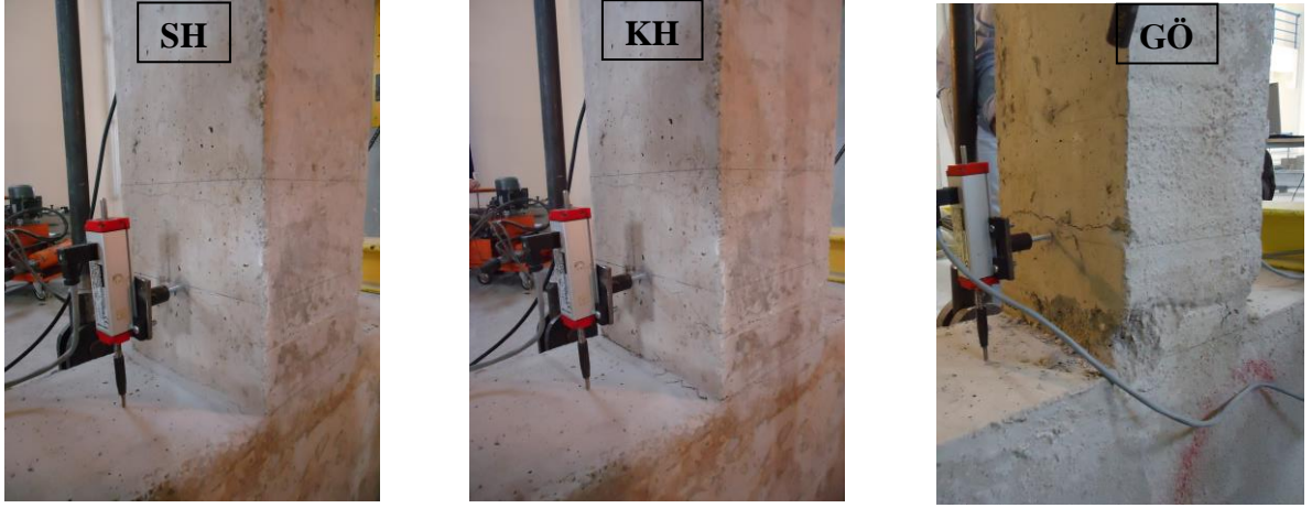
Şekil 4.70: SZ414-6 numunesi hasar sınırlarına karşılık gelen hasar durumları
