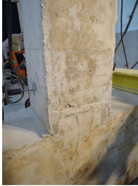
Şekil 4.63: SA414-2 SH performans düzeyi için numune hasar düzeyi
