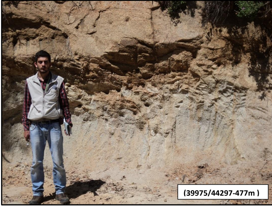
Şekil 2.18: Bıçkıtarla batısında arenalaşmış olarak yüzlek veren Şaroluk Granitoyidi.
