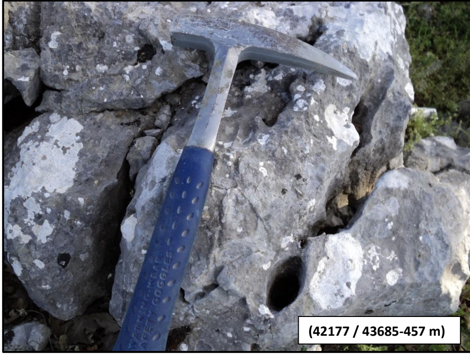
Şekil 2.10: Bilecik Formasyonu olarak tanımlanan kireçtaşları içerisindeki karstik boşluklar.
