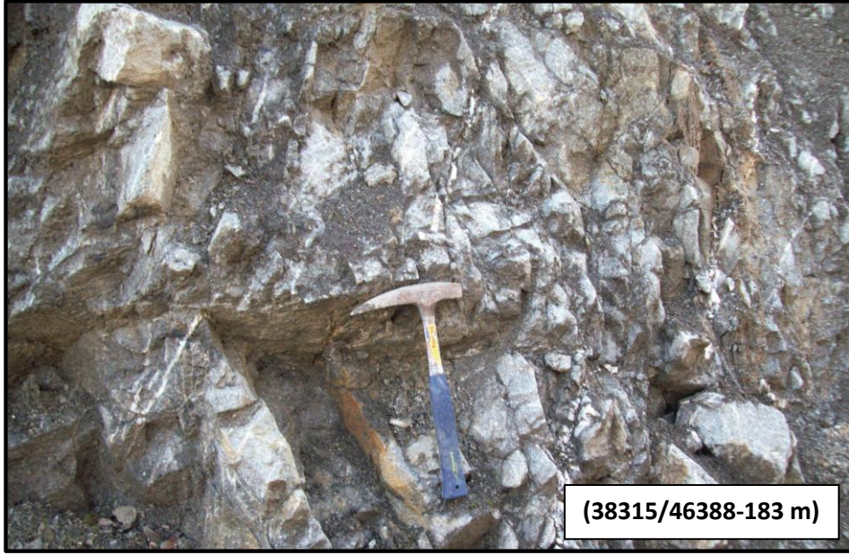
Şekil 2.7: Karakaya Formasyonu içerisinde gözlenen olistolit karakterli Permiyen yaşlı kireçtaşı.
