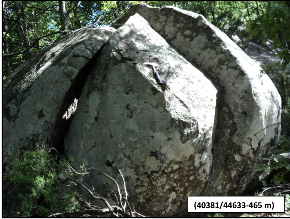
Şekil 2.20: Şaroluk Granitoyidi'ne ait blok içerisinde gelişen makaslama çatlakları.
