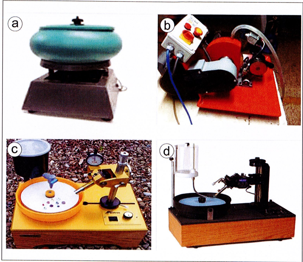
Şekil 3.30: Mücevhertaş işleme makinaları a-) Tambur makinası, b-) Tesbih makinası, c-) Faset makinası, d-) Faset makinası (Silica-Gem Tur. San. Tc. Ltd. İzniyle)
