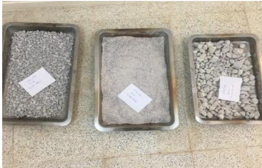
Şekil 4.8: Soldan sağa 5-12 mm, 0-5 mm, 12-22 mm çapta agrega numuneleri.
