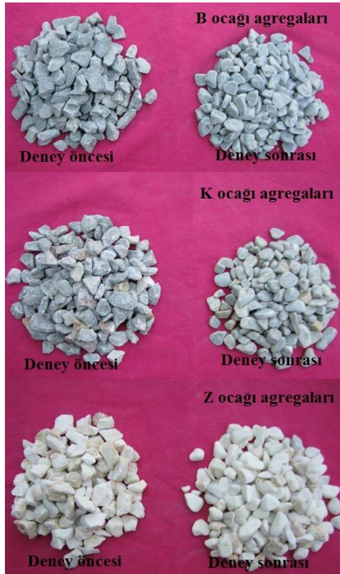
Şekil 4.15: Micro Deval deneyi öncesi ve sonrası agrega numunelerinin görünümü.
