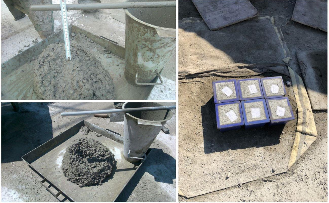
Şekil 4.25: Taze beton deneyleri ve taze betonun kalıplara yerleştirilmesi.
