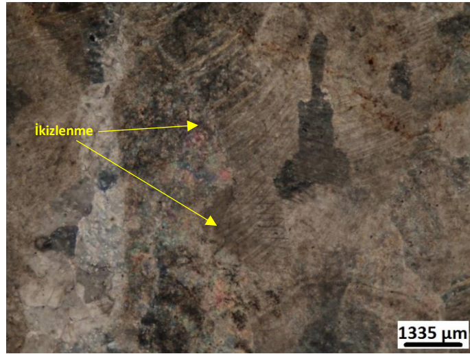
Şekil 3.10: Z3 kesitinde görülen mükemmel hasır ikizli kalsit kristalleri ve büyük kalsit damarı.
