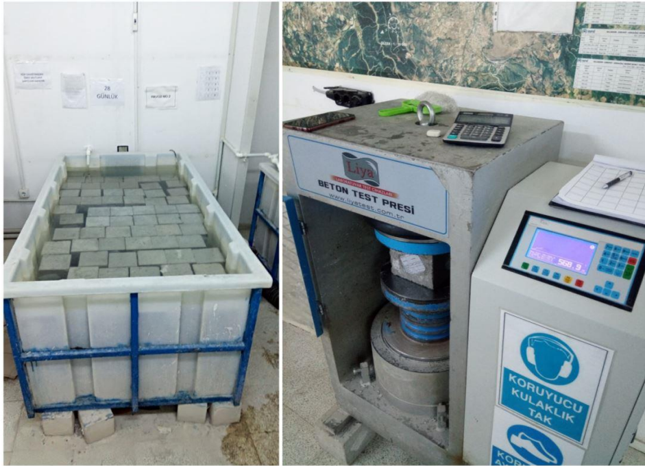
Şekil 4.26: Kür havuzu ve beton basınç dayanımı testi fotoğrafları.
