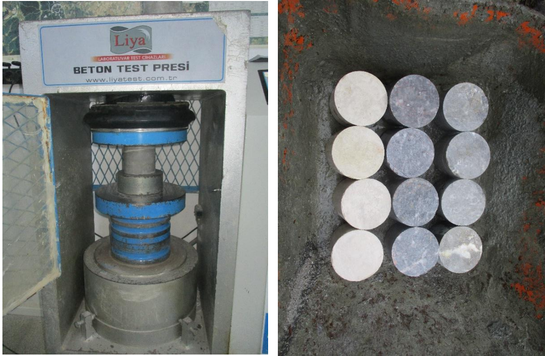
Şekil 4.5: Tek eksenli basınç dayanımı deneyi fotoğrafları.
