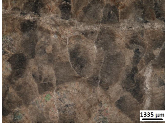
Şekil 3.8: K4 kesitinde görülen kalsit mineralleri ve içerdiği ikincil damarların görünümü.
