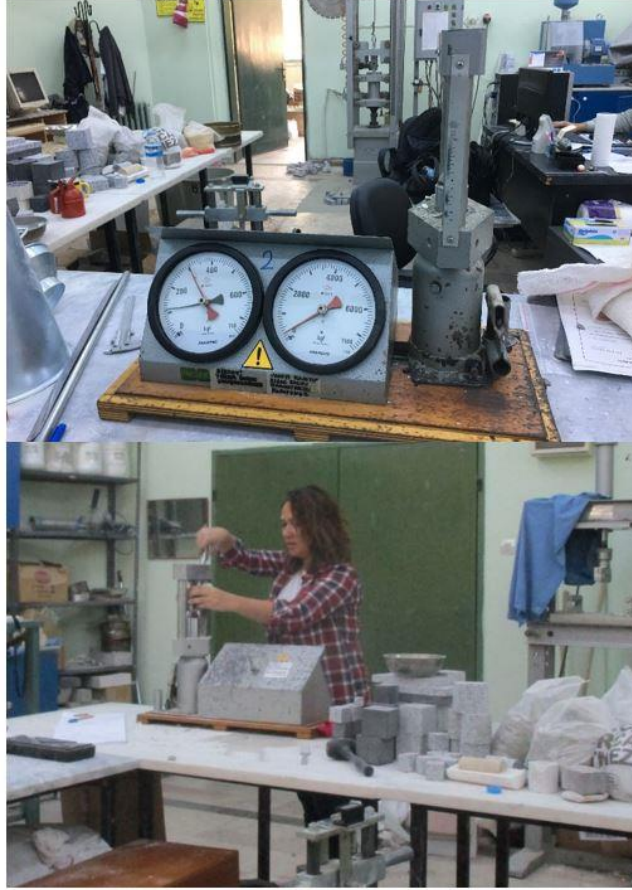
Şekil 4.3: Nokta yük dayanım indisi deney cihazı ve deneyin yapılışı.
