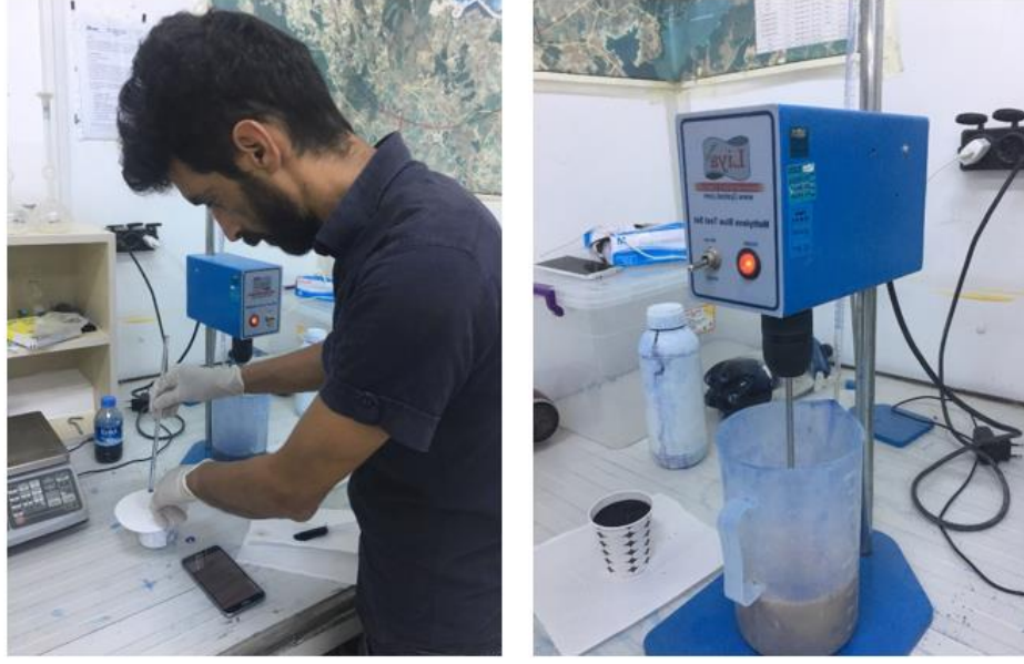
Şekil 4.18: Metilen mavisi deneyi cihazı ve deneyin yapılışı.
