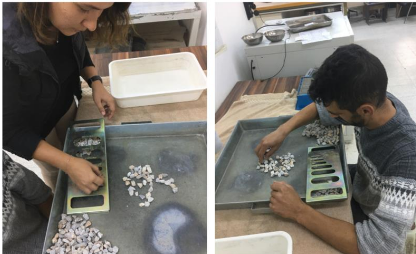
Şekil 4.12: Yassılık şablonu ile eleme.
