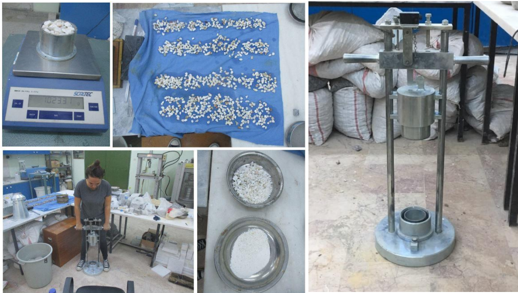
Őekil 4.17: Agrega darbe dayanımı deneyi cihazı ve deneyin yapılıřı.
