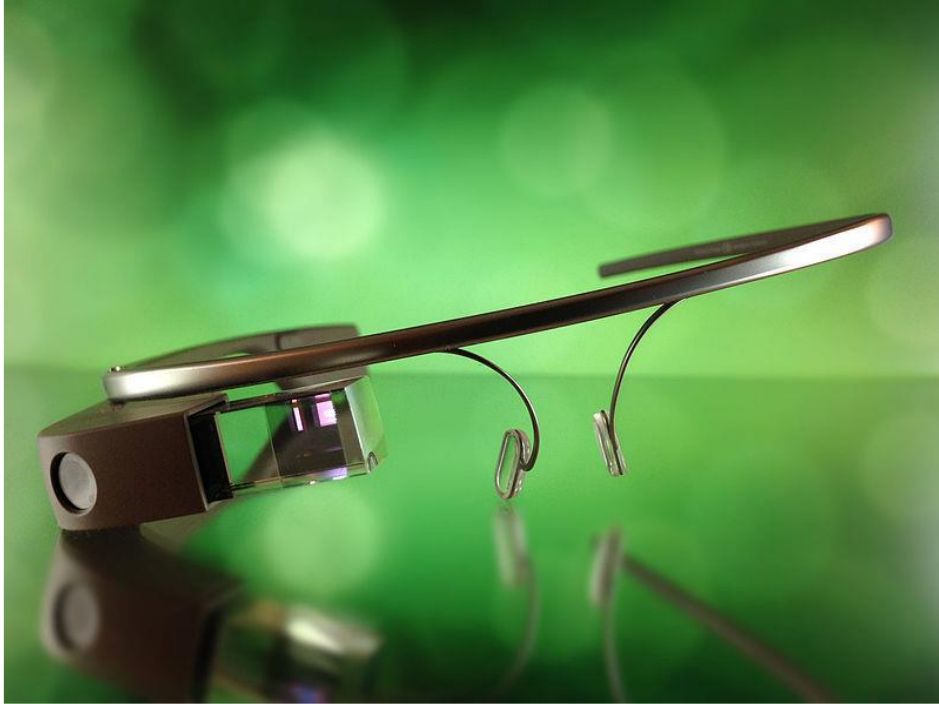
Şekil 2.18: Google Glass optik gösterici (Xcompany, 2019).
