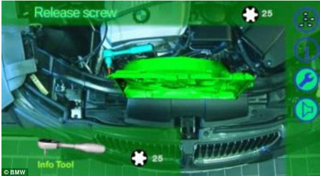
Şekil 2.26: BMW servislerinde AG kullanımı (Elearningsuperstars, 2019).
