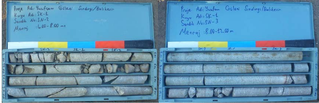
Şekil 2.8: SK-1 Sondaj kuyusundan çıkarılan karot örnekler (DSİ ve Sepa Müh. Müş. İnş. Tic. Ltd. Şti, 2015).
