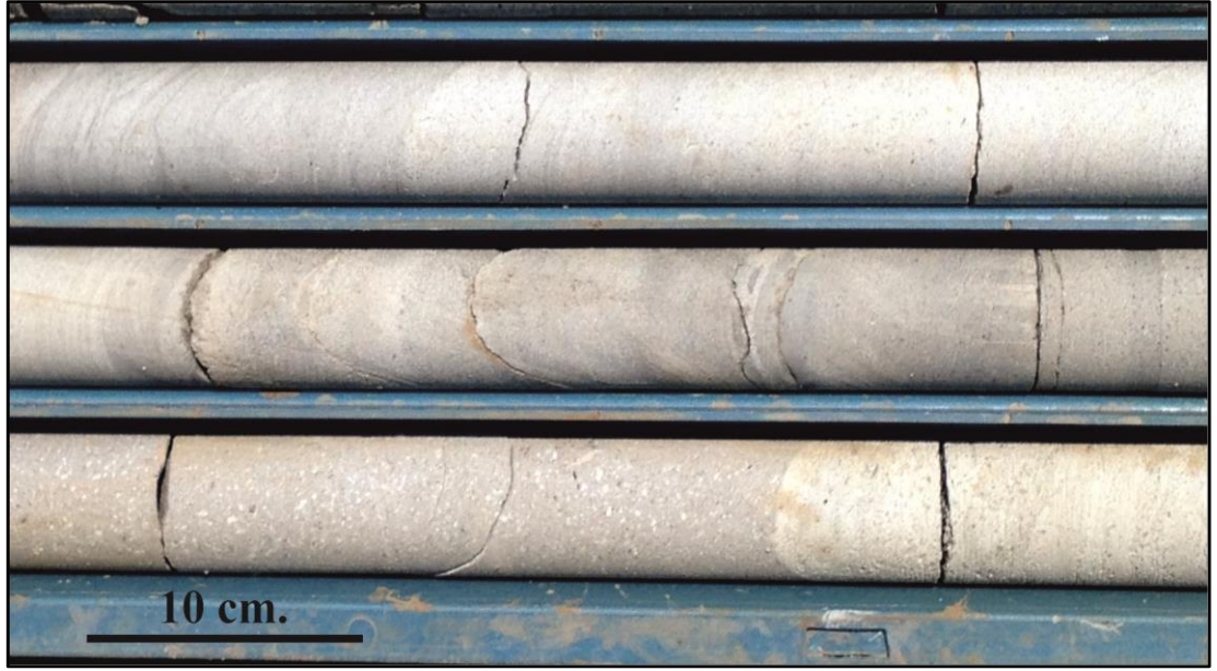
Şekil 6.28: Fasiyes 17, Tüfler, Enerji Madencilige ait SK 7 (EK C7) numaralı sondajın 296-299. metreleri arası (Karot kalınlıkları HQ = 63,5 mm).
