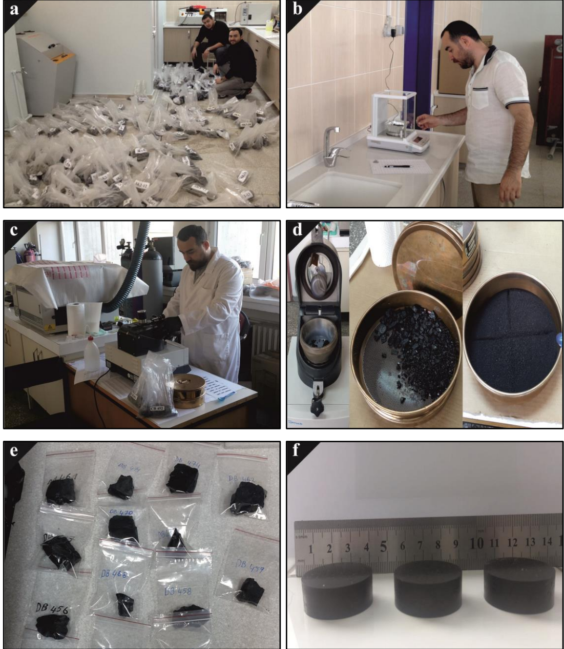
Şekil 2.4: Laboratuvar çalışmaları kapsamında gerçekleştirilen örnek hazırlama aşamaları. a) Araziden biyostratigrafi, kumtaşı petrografisi, kömür petrografisi ve jeokimyası için derlenen örneklerin tasnifi, b) Kömür petrografisi ve jeokimyası için ayrılan örneklerin nem tayini için tartım işlemleri, c) Kömür petrografisi ve jeokimyası için örneklerin öğütme işlemi, d) Kömür petrografisi ve jeokimya çalışmaları sırasında öğütme, çeyrekleme ve eleme aşamaları e) Kömür vitrini yansıma ölçümleri için örnekleri seçimi, f) Kömür petrografisi SEM-EDX çalışmaları için hazırlanmış briketler.
