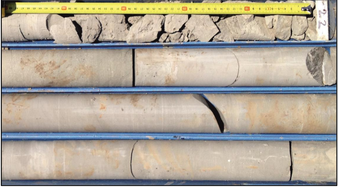
Şekil 6.20: Fasiyes 13, Masif marnlar, Enerji Madencilğe ait SK 7 (EK C7) numaralı sondajın 21-33 metreleri arası (Karot kalınlıkları HQ = 63,5 mm).
