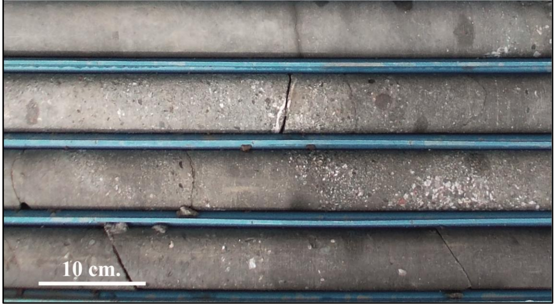
Şekil 6.10: Fasiyes 7, Kaba kumtaşı arakatlı silttaşları, Enerji Madencilige ait SK 9 (EK C9) numaralı sondajın 361-365 metreleri arası (Karat kalınlıkları HQ = 63,5 mm).
