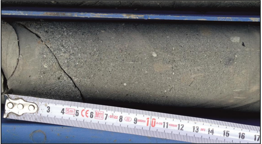
Şekil 6.8: Fasiyes 5, Dereceli kumtaşları, Enerji Madenciliğe ait SK 8 (EK C8) numaralı sondajın 245-250 metreleri arası (Karot kalınlıkları HQ = 63,5 mm).
