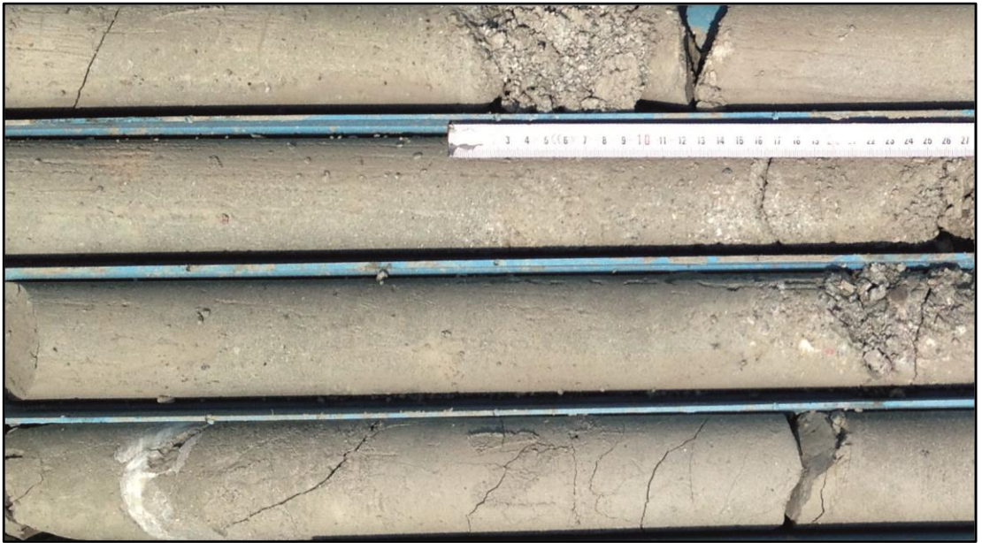
Şekil 6.6: Fasiyes 4, Masif kumtaşları, Enerji Madenciliğe ait SK 9 (EK11) numaralı sondajın 125-132 metreleri arası (Karot kalınlıkları HQ = 63,5 mm).
