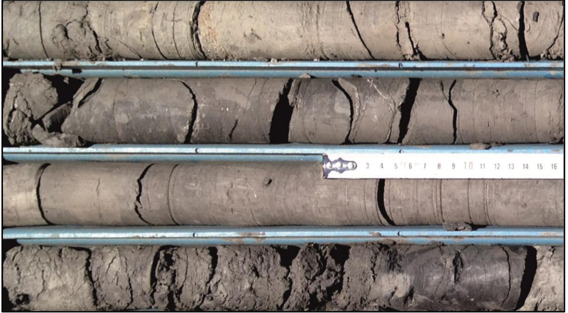
Şekil 6.14: Fasiyes 10, Organik malzemeli kiltaşları, Enerji Madenciliğe ait SK 8 (EK C8) numaralı sondajın 381-384 metreleri arası (Karot kalınlıkları HQ = 63,5 mm).
