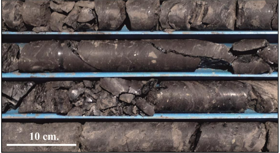
Şekil 6.27: Fasiyes 16, Kömürler, Enerji Madenciliğe ait SK 8 (EK C8) numaralı sondajın 378-381 metreleri arası (Karot kalınlıkları HQ = 63,5 mm).
