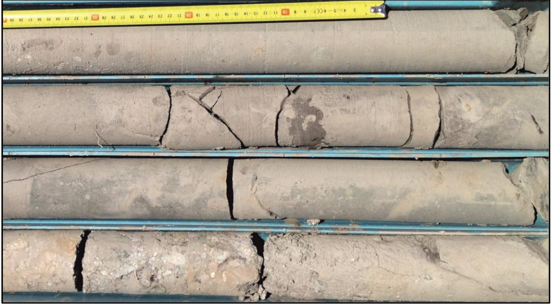
Şekil 6.12: Fasiyes 9, Masif çamurtaşları, Enerji Madenciliğe ait SK 7 (EK C7) numaralı sondajın 177-184 metreleri arası (Karot kalınlıkları HQ = 63,5 mm).
