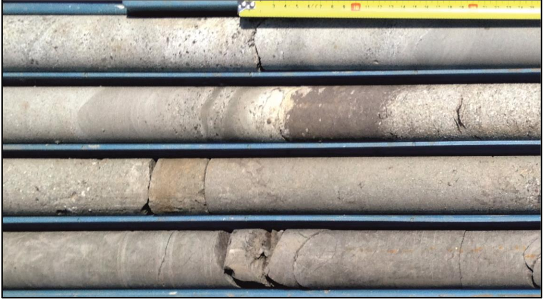
Şekil 6.11: Fasiyes 8, İnce taneli kumtaşı-silttaşı ardalanması, Enerji Madencilige ait SK 7 (EK C7) numaralı sondajın 263-269 metreleri arası (Karot kalınlıkları HQ = 63,5 mm).
