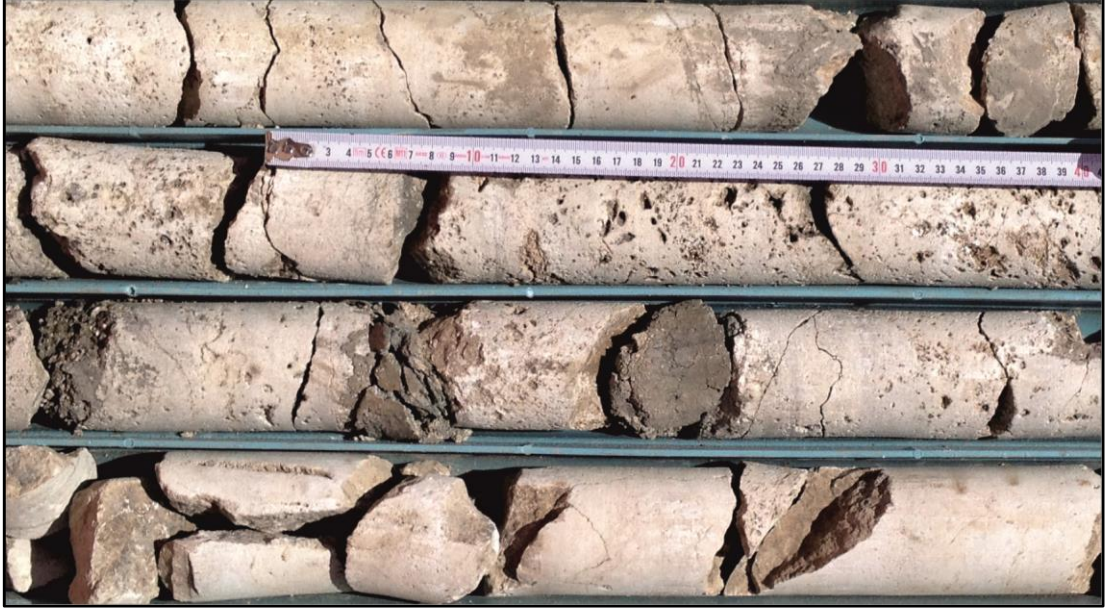
Şekil 6.22: Fasiyes 14, Kireçtaşları, Enerji Madenciliğe ait SK 9 (EK C9) numaralı sondajın 85-87. metreleri arası (Karot kalınlıkları HQ = 63,5 mm).
