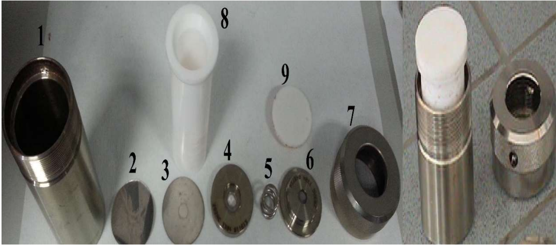
Şekil 2.2: Parr asit sindirme reaktörü ve parçaları. (1) paslanmaz çelikten yapılmış reaktörün dış kabı, (2) korozyon disk, (3) patlama disk, (4) düşük basınç plakası, (5) düşük ve yüksek basınç plakalarını dengeleyici yay, (6) yüksek basınç plakası, (7) reaktörün dış kapağı, (8) Çözeltilerin konulduğu teflon kap ve (9) teflon kabın kapağı.
